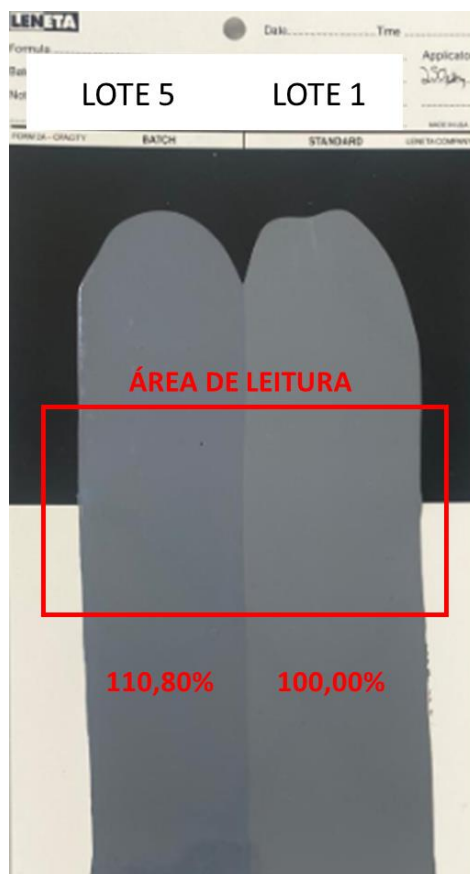
Figura 4.3.4 – Extensão em cartela do corte com preto dos lotes de maior e menor Transmissão para o Fabricante C.
