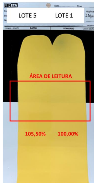
Figura 4.2.4 – Extensão em cartela do corte com branco dos lotes de maior e menor Transmissão para o Fabricante B.
