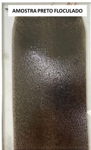
Figura 2.6.6 - Imagem microscópica da extensão em vidro de um concentrado preto com alto nível de floculação.
