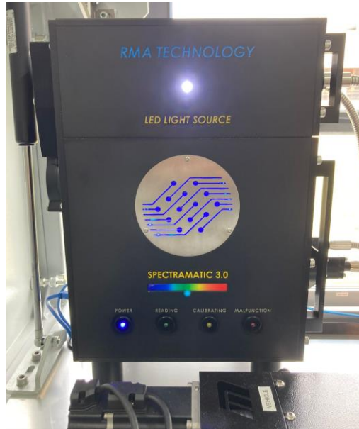
Figura 2.5.5 - Espectrofotômetro de duplo feixe e fonte luminosa.
