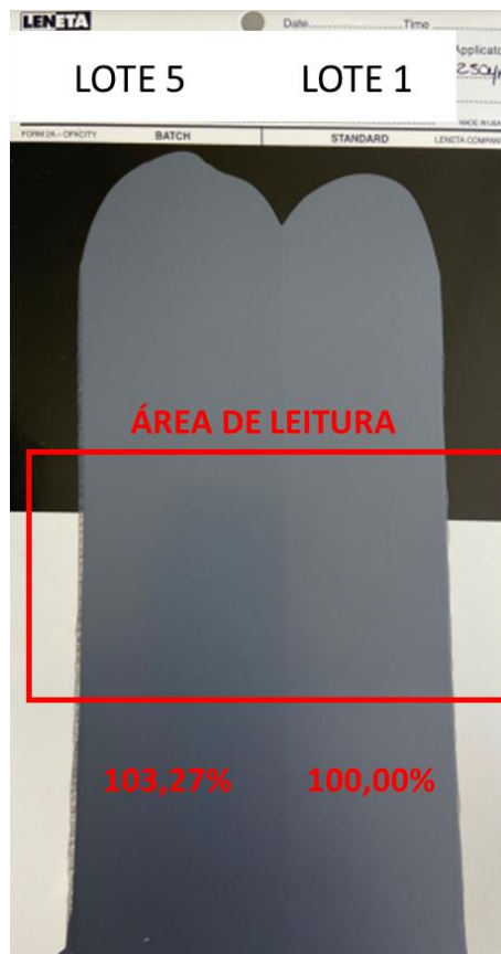
Figura 4.4.4 – Extensão em cartela do corte com branco dos lotes de maior e menor Transmissão para o Fabricante D.
