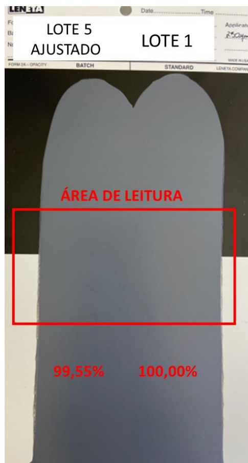
Figura 4.4.9 – Aplicação em cartela para verificação da Força de Tingimento do lote ajustado e do lote no limite inferior da especificação do Fabricante D.
