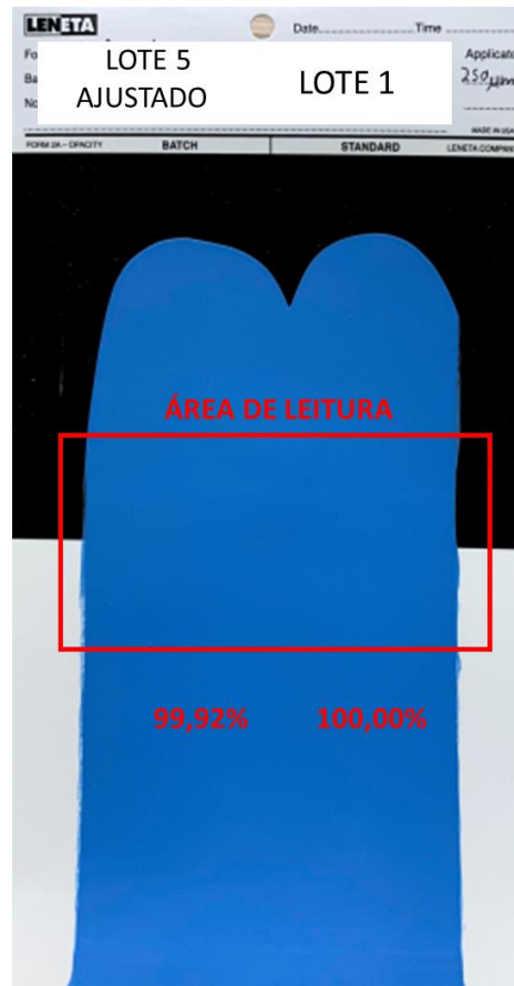
Figura 4.1.9 – Aplicação em cartela para verificação da Força de Tingimento do lote ajustado e do lote no limite inferior da especificação do Fabricante A.
