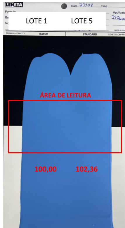
Figura 4.1.4 – Extensão em cartela do corte com branco dos lotes de maior e menor Transmissão para o Fabricante A.
