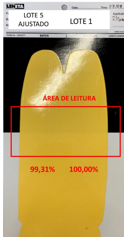
Figura 4.2.9 – Aplicação em cartela para verificação da Força de Tingimento do lote ajustado e do lote no limite inferior da especificação do Fabricante B.
