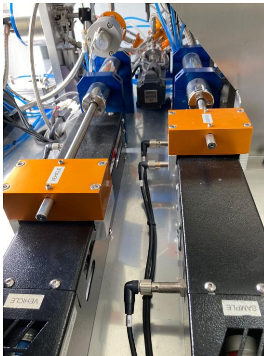
Figura 2.5.2 - Seringas dosadoras volumétricas de alta precisão.
