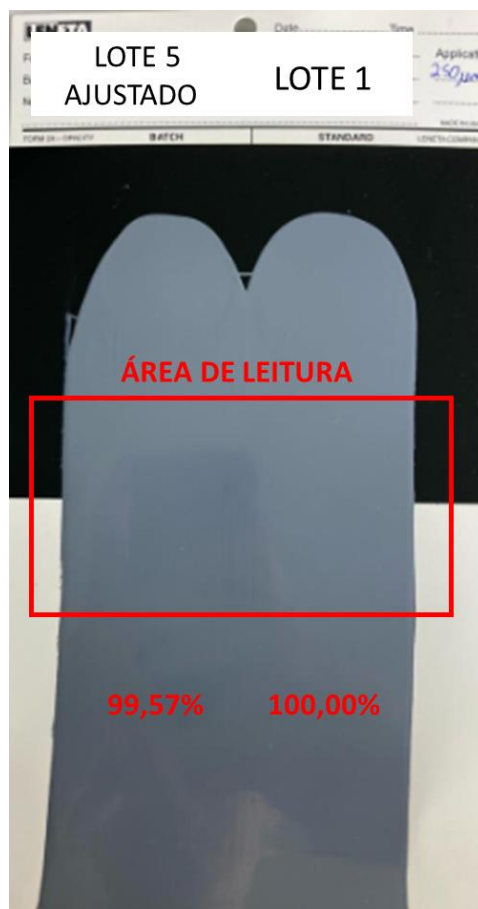
Figura 4.3.9 – Aplicação em cartela para verificação da Força de Tingimento do lote ajustado e do lote no limite inferior da especificação do Fabricante C.
