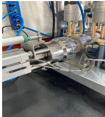
Figura 2.64 - Câmara do micromixer .
