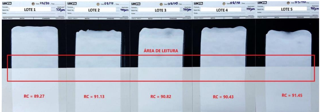
Figura 4.34 - Aplicações em cartela dos cinco lotes do Fabricante C.
